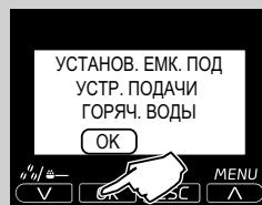
**14** Нажмите кнопку "OK", чтобы подтвердить наличие емкости под устройством подачи воды.
