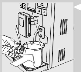
**5** По завершении подачи опорожните емкость и снова установите ее под устройство подачи воды.
