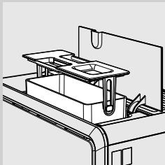
**6** Достаньте бак для воды с помощью ручки, расположенной на внутренней крышке.
