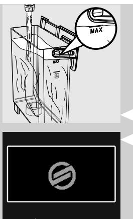
**13** По окончании еще раз наполните бак для воды до уровня MAX. С этого момента машина может использоваться для подачи кофе. На дисплее отобразится символ, указанный сбоку.
