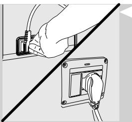
**11** Вставьте штепсельную вилку в розетку, расположенную в задней части машины.
