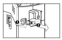
**2** Слегка наклоните насадку Cappuccinatore. Полностью вставьте ее в направляющие машины.
